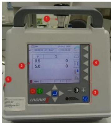
2 pav. Lasair III 310C: 1 – izokinetinį mėginių ėmimo zondas, 2 – terminio spausdinimo popierius, 3 – valdymo skydelis, 4 – programinius mygtukai (Šaltinis: Intersurgical, 2020)
