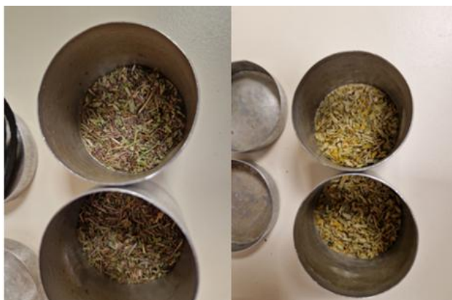
2 pav. Paruošti mėginiai drėgmės (nuodžiūvio) tyrimui Šaltinis: sudaryta autorių
