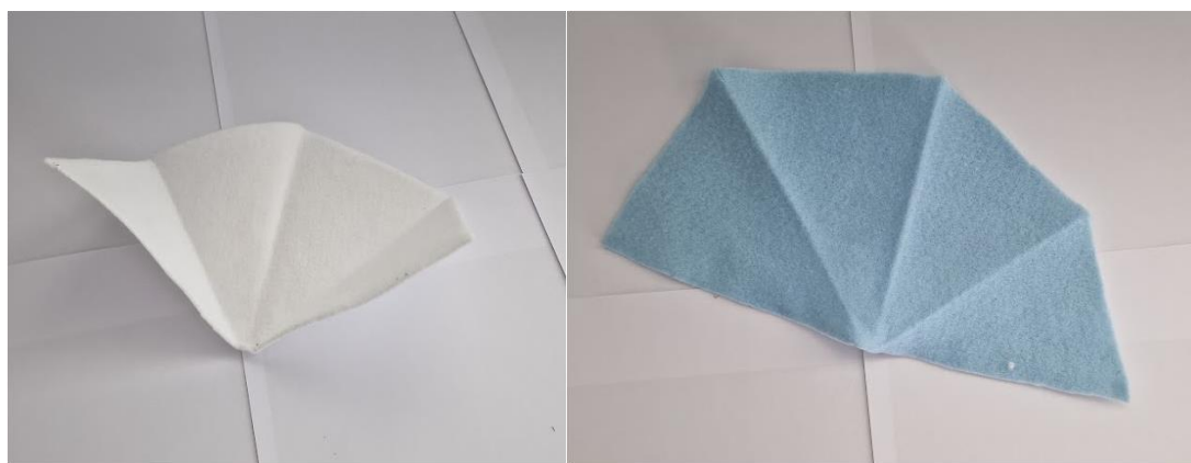
a b 4 pav. 3,00 mm (a) ir 0,7 mm (b) veltinis po lyginimo
